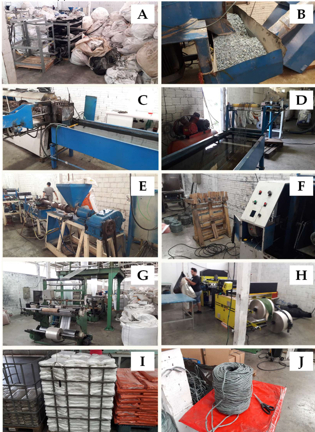
Figura 2. Processo de produção da empresa do estudo: Material prima (A); Material aglutinado (B); processo de extrusão (C); Produção do granulo (D); Processo de produção do fitilho liso (E); processo de produção do fitilho transado; (F); transformação do fitilho em sacolas (G/H); Produto final – sacolas (I) e fitilhos transados (J).
