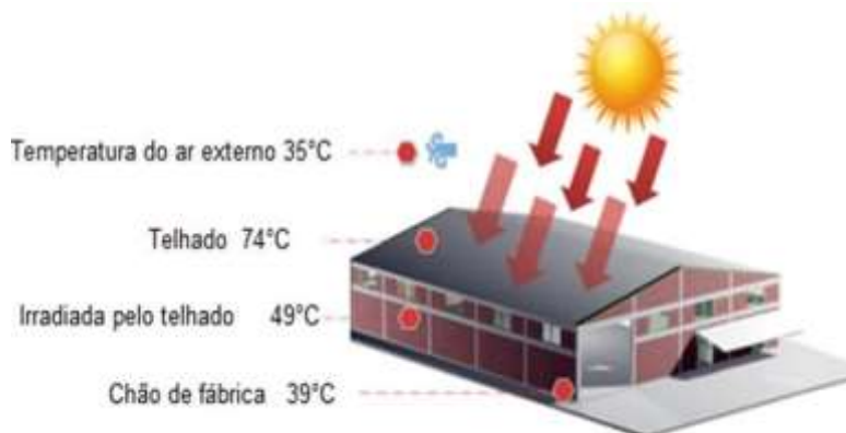
Figura 1 - Cobertura sem Refrigeração
