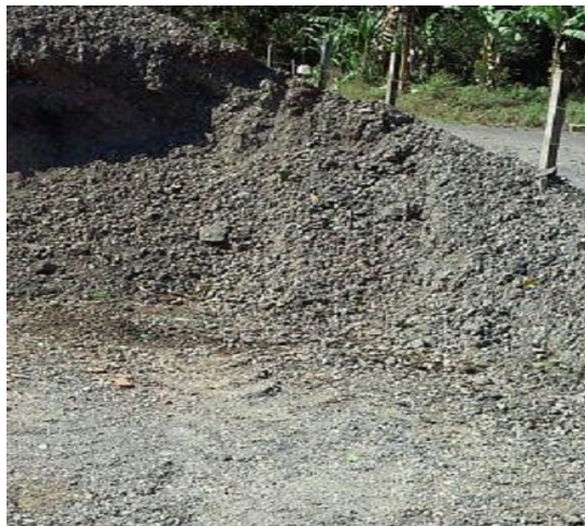
Figura 6: Material de Fresagem com Material de Base em Joinville
