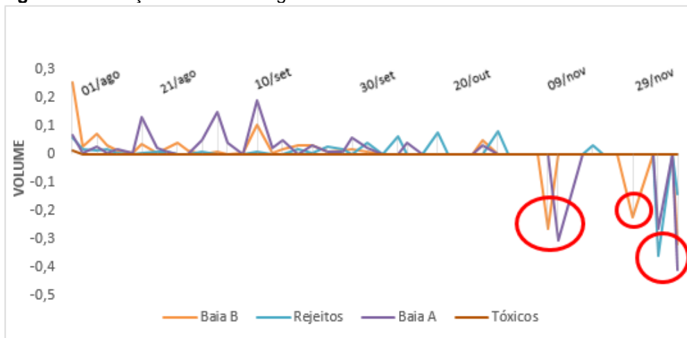
Figura 4 – Geração de RCC de agosto a novembro na obra de reforma.
