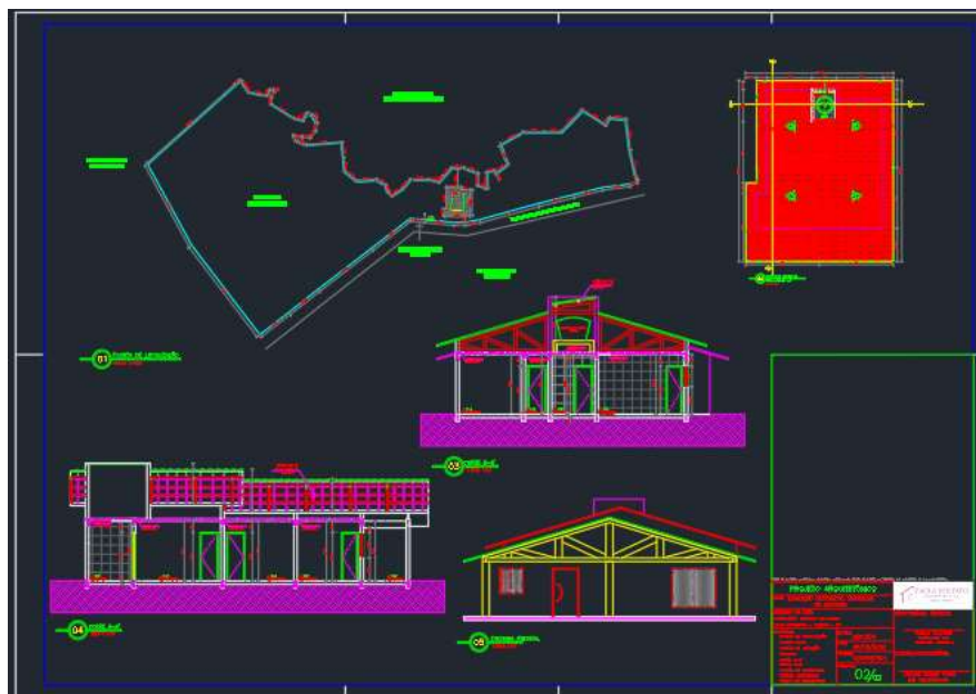
Figura 5 – Planta de telhado, locação, cortes e fachada
