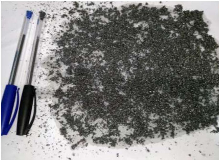
Figura 2 - Resíduo (Cavaco de aço)
