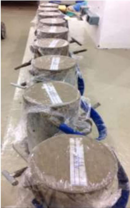
Figura 5 - Corpos-de-prova do concreto convencional
