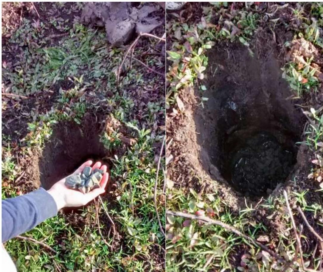
Figura 3 – Ensaio de percolação - preenchimento da cava com pedra brita
