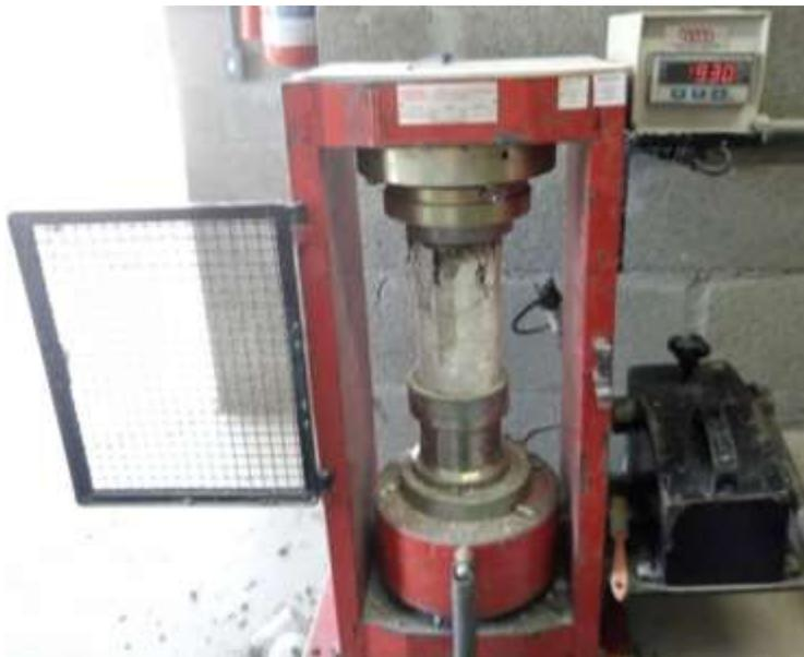
Figura 4 - Ensaio de compressão
