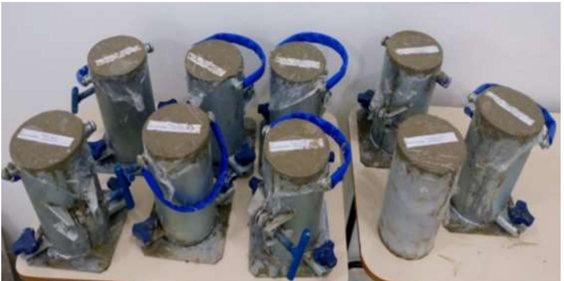
Figura 3 - Corpos-de-prova dos três traços de concreto
