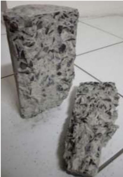
Figura 7 – Corpo-de-prova rompido aos 28 dias com 15 % de substituição
