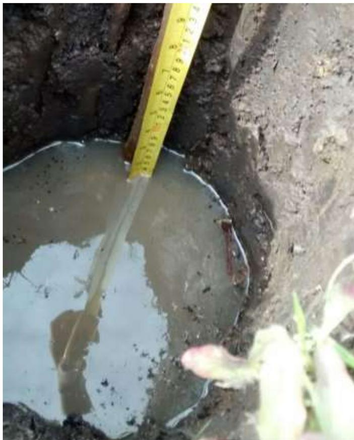
Figura 4 – Cava após 3 horas de saturação
