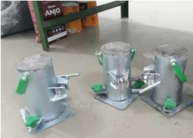
Figura 3 – Moldagem dos Corpos de Prova
