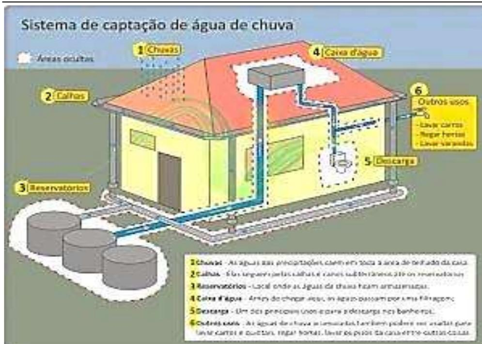
Figura 01 – Sistema de captação de água da chuva
