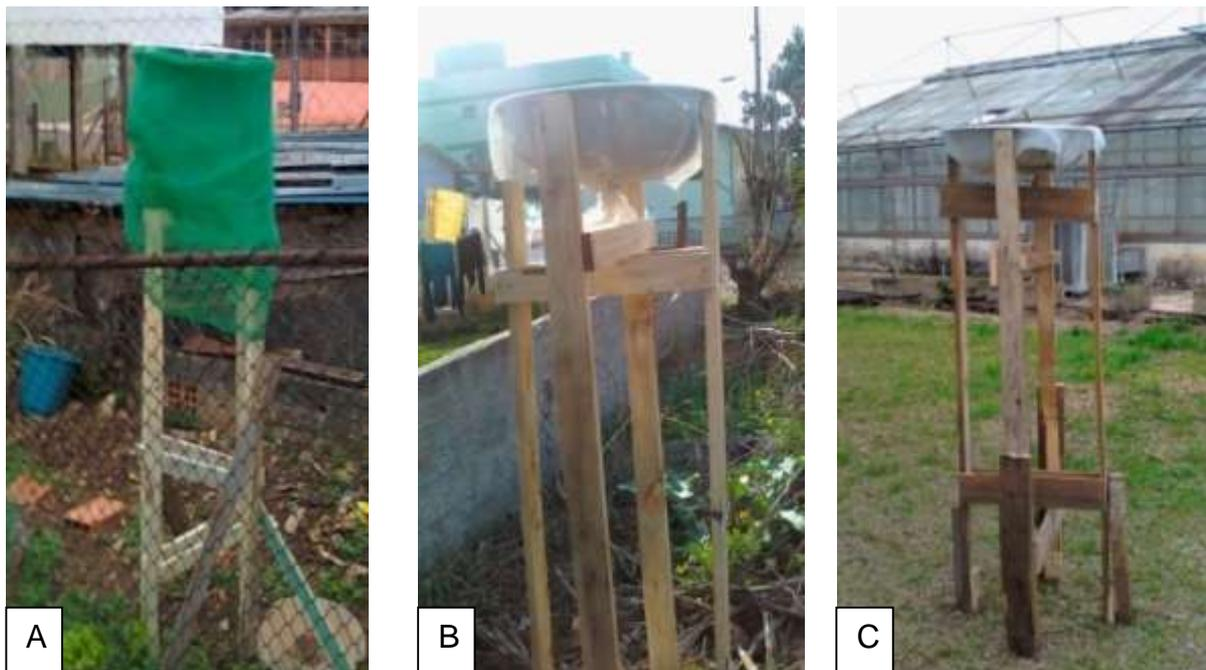
As amostras de água de chuva foram coletadas com uma bacia de inox, com 39 cm de diâmetro e capacidade de 10 litros. A bacia ficou apoiada em quatro armações de madeira a 1,5 m do solo, amarrada nos quatro cantos com fio de arame liso galvanizado e coberta por uma tela de nylon. Assim, as amostras ficaram longe do contato com o solo e/ou possíveis contaminantes que pudessem entrar em contato com a água coletada.
