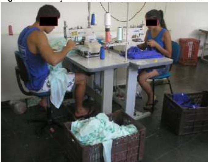
Figura 1: Execução do caseamento das camisas no setor de acabamento.
