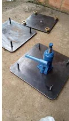
Figura 2 : mostra a prensa em partes em seu processo de montagem ( foto retirada pelos acadêmicos).
