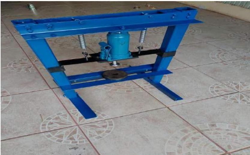
Imagem 5 – prensa hidráulica (foto tirada por acadêmico)
