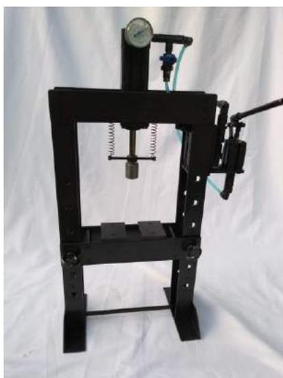
Figura 3 - Prensa hidráulica
