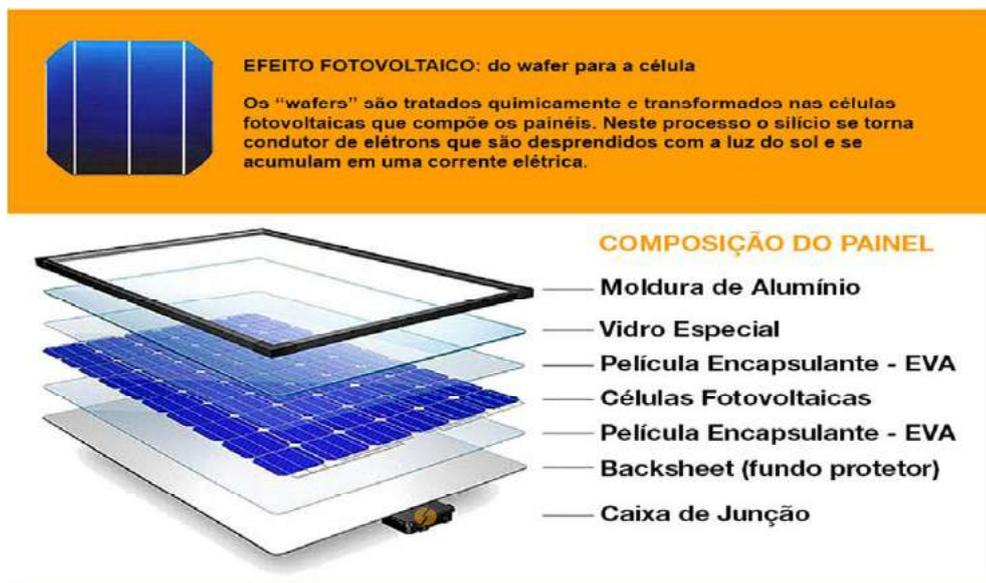
Fig. 3 – Estrutura física de uma placa fotovoltaica
