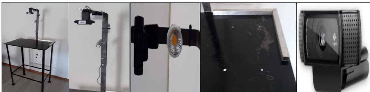
Figura 1: Mesa Posicionadora, suporte, iluminação, gabarito e câmera
