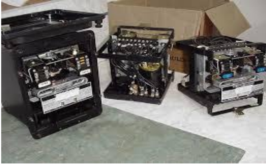
Fig. 2 – Relés eletromecânicos Fonte: Labspot Ufsc
