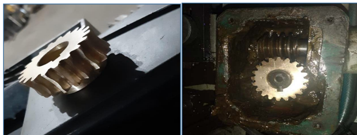
Figura 2- Redutor de velocidade finalizado e acoplado na caixa redutora
